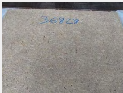
Een thermoplastische compound zorgt ervoor dat het oppervlak van een houtvezelplaat minder open is waardoor er minder beschermende lagen nodig zijn tegen waterabsorptie.
