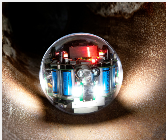
De I-Ball kan zelfstandig door een vat of leiding rollen en er visuele en ultrasone inspecties uitvoeren.
